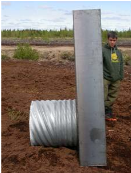
Figure 1.11 : Barrage utilisé pour les essais sur la hauteur de la nappe d'eau à Pointe-Lebel (Québec). Photo : Guillaume Théroux Rancourt.
