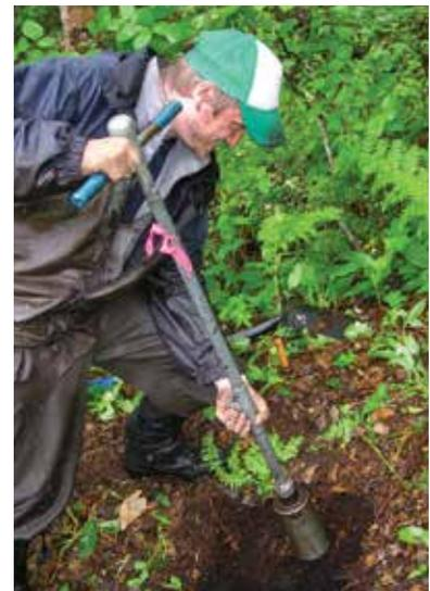
Figure 5. Sonde pédologique servant à extraire une carotte de sol aux fins de l'analyse des fragments de charbon de bois des sols d'AcérUL.
